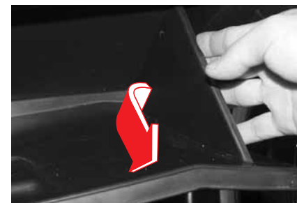
3. Enfoncez le côté droit de la boîte à gants dans le sens de la flèche.
