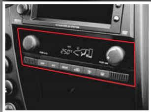
Panneau de commande de chauffage/climatisation
