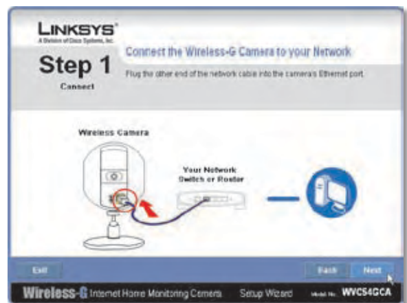
Sluit de netwerkkabel aan op de camera
