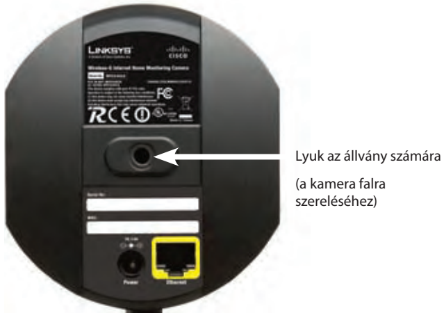
A kamera falra szerelése
