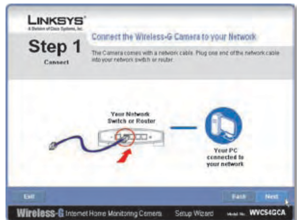
Conexión del cable de red al router o switch
