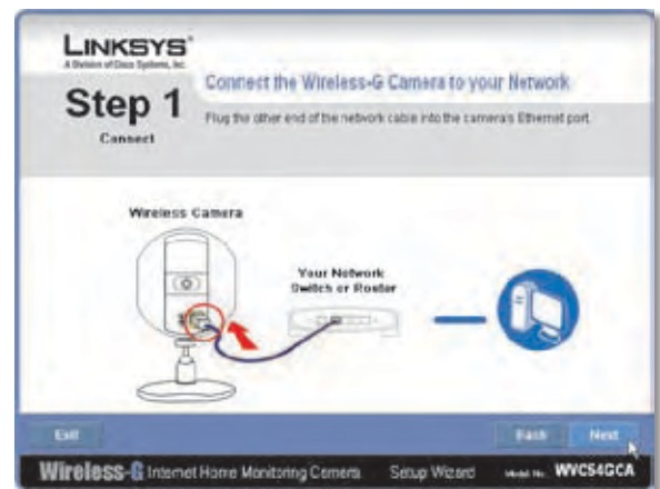
Connexion du câble réseau à la caméra
