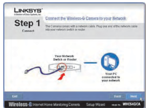
Netzwerkkabel an Switch oder Router anschließen
