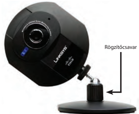
A kamera dőlésszögének beállítása álló helyzetben
