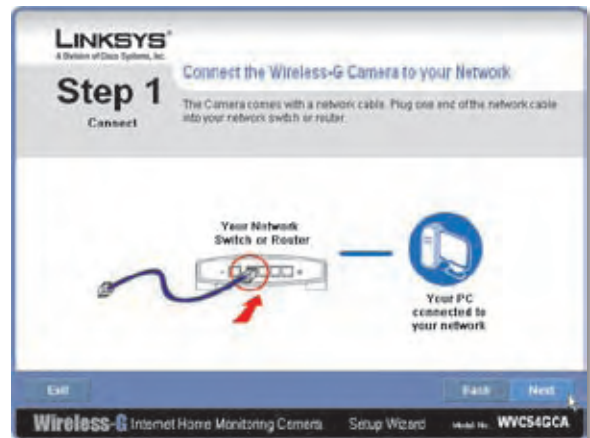
Csatlakoztassa a mellékelt hálózati kábelt (UTP) routeréhez vagy switch-éhez
