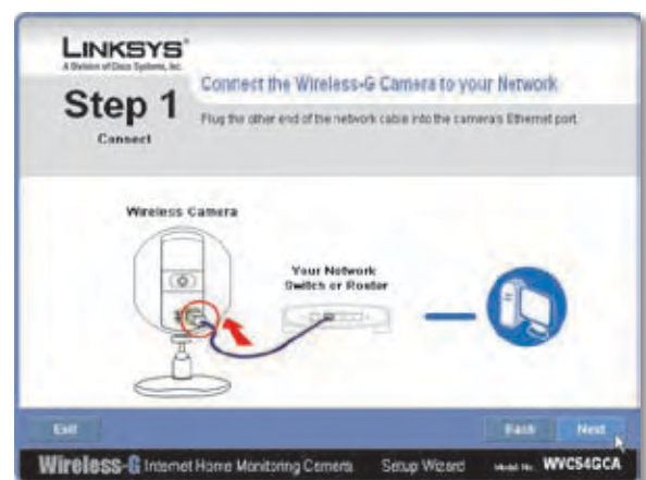
Netzwerkkabel an die Kamera anschließen
