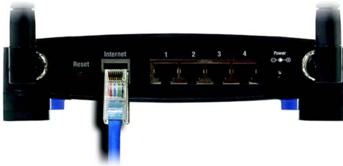
Figure 4-6 : Connectez le port Internet du routeur haut débit au port Ethernet numéroté de l'autre routeur
