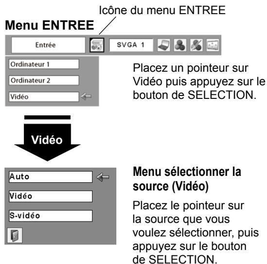
**Auto** Lorsque vous sélectionnez le réglage Auto, le projecteur détecte automatiquement le signal vidéo qui lui parvient et se règle pour obtenir les meilleures performances possibles. Le projecteur sélectionne la connexion dans l'ordre suivant:
