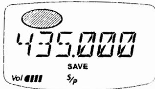
bandes. Vous pouvez vérifier que vous êtes en mode VFO en regardant au-dessus du digit des "Dizaines - de - MHz" de la fréquence d'emploi. Si aucun nombre n'est visible à la position marquée sur le schéma, vous êtes en mode VFO.
