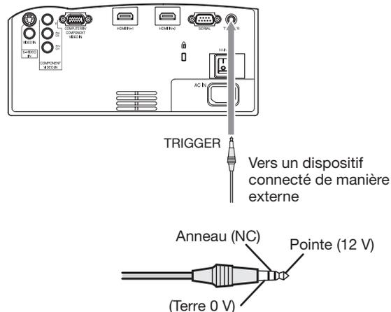
Si vous souhaitez utiliser la borne TRIGGER, réglez DECLENCHEUR sur ECRAN ou ANAMORPHIQUE dans le menu INSTALLATION. (Le paramètre par défaut est ARRET. Voir page 27 pour de plus amples détails.) Procédez comme suit pour modifier le paramètre.
