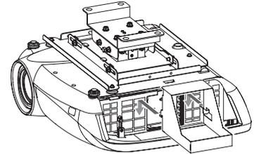
3. Fixez le plateau de remplacement de la lampe au projecteur en utilisant le ruban livré avec le plateau.
