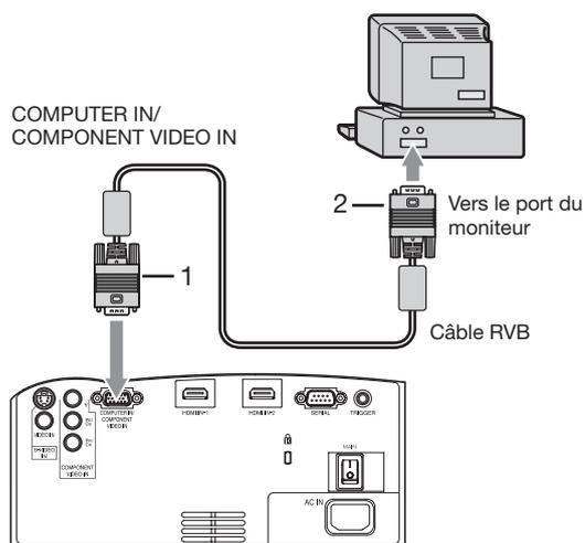
1. Connecter une extrémité du câble RVB fourni à la borne COMPUTER IN/COMPONENT VIDEO IN du projecteur.
