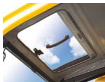
Toit vitré avec pare-soleil coulissant
