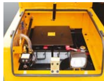
Compartiment de grandes dimensions avec pompe de remplissage de carburant
