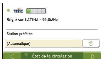
La section **Syntoniseur** permet d'afficher le nom et la fréquence de la station actuellement utilisée pour recevoir des informations sur la circulation. Une barre affiche la puissance du signal reçu ; plus la barre d'état (en vert) est importante, plus le signal est puissant.
