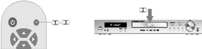
Öffnen Sie die Lade des CD Laufwerkes, das Gerät befindet sich im DVD Modus. Drücken Sie bitte hierzu die OPEN/CLOSE Taste, entweder an der Fernbedienung oder an der Frontseite des Gerätes.
