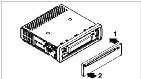
Zet het bedieningselement eerst aan tegen de rechterzijde en klik het vervolgens aan de linkerzijde in.
