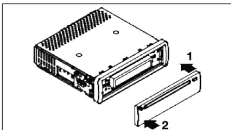
Setzen Sie die Bedienblende erst an der rechten Seite an und rasten Sie sie dann auf der linken Seite ein.
