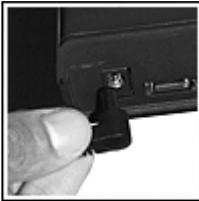
1. Raccordez la Freebox à l'extrémité du bloc d'alimentation.
