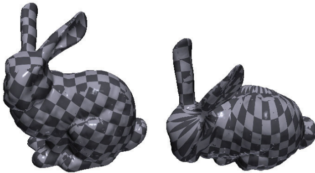
Texture reparamétrée à l'aide des options Déformation légère (à gauche) et Moins de coutures (à droite)
