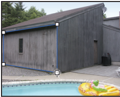
Définition des quatre nœuds d'angle du plan
