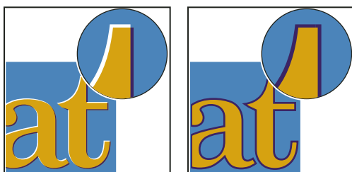
Problèmes de repérage des encres sans recouvrement (à gauche) et avec recouvrement (à droite)
