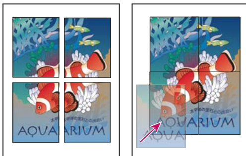
Pages grand format divisées en mosaïques imprimables (à gauche) et sections se chevauchant à l'assemblage final (à droite)
