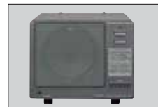
SP-20 HP EXTERNE Équipé de 4 filtres audio et d'une prise casque. Possibilité de connecter deux transceivers simultanément. Impédance 8 Ω. Puissance maximum 5 W.
