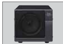
SP-21 HP EXTERNE Impédance 8 Ω. Puissance maximum 5 W.
