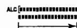
Règle la valeur [COMP Level] à l'aide du vernier de réglage, de sorte à ce que l'indicateur de niveau COMP ne dépasse pas la limite de la zone de niveau COMP.
