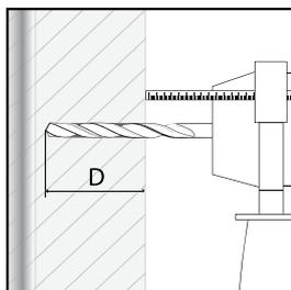
La butée de profondeur permet de réaliser des trous calibrés sans risques de traverser le matériau.
