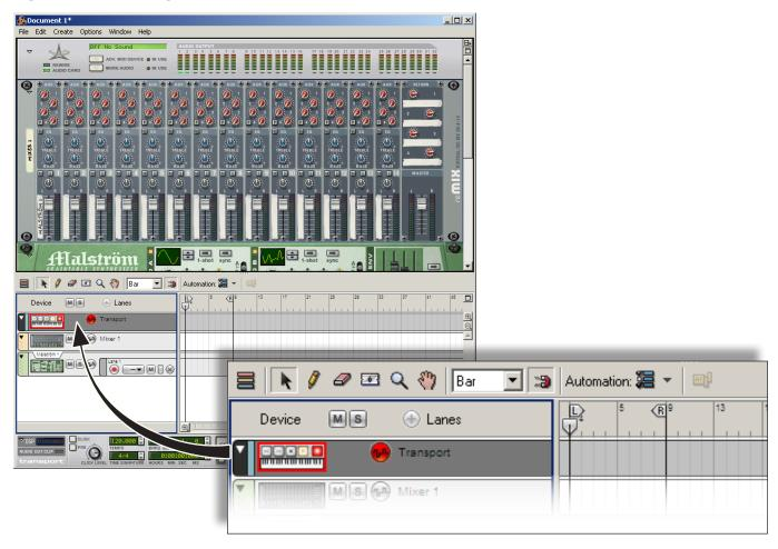
Reason offre une piste "transport" en haut de son séquenceur. Quand cette piste est sélectionnée, les encodeurs peuvent être utilisés pour contrôler le séquenceur et la barre de transport des manières suivantes :
