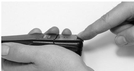
**Repositionnez le couvercle du compartiment à piles. Alignez le loquet à la fente, figure de gauche. Appuyez sur le bas du couvercle, figure de droite.**
