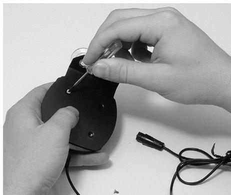
**Fixer l'antenne du iFINDER au support pour pare-brise avec deux vis.**
