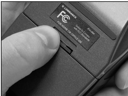
Repositionnez le couvercle du compartiment à piles. Alignez les pattes du couvercle avec les fentes présentes à la base du boîtier (gauche). Appuyez fermement sur l'onglet jusqu'à entendre un clic (droite).
