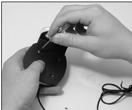
**Fixez l'antenne du iFINDER au support pour pare-brise avec deux vis.**
