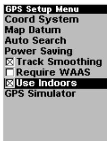
Fenêtre de sélection de la commande Use Indoors (utilisation en intérieur) dans le Menu GPS Setup. Avec la commande sélectionnée, comme illustré sur cette figure, le système GPS est désactivé pour économiser de l'énergie.
