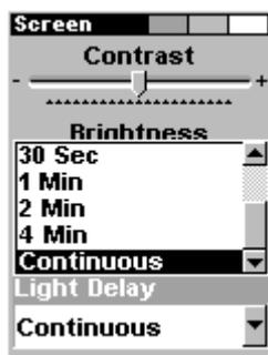
Menu Light Delay. Ici, le réglage sélectionné est "continuous" (continu), ce qui est idéal pour une utilisation de nuit dans un véhicule et avec une alimentation extérieure.
