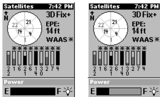
Capacité des piles affichée dans la fenêtre "Power" en bas de l'Écran Satellite. La figure de gauche montre une capacité maximale avec des piles neuves. À droite, il reste aux piles approximativement 25% de leur puissance initiale.
