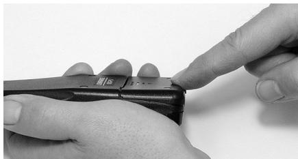
**Repositionnez le couvercle du compartiment à piles. Alignez le loquet à la fente, figure de gauche. Appuyez sur le bas du couvercle, figure de droite.**
