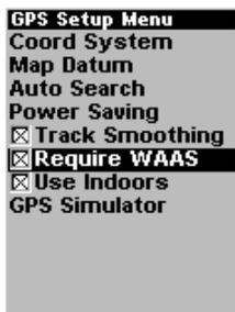
**Commande d'utilisation du WAAS dans le Menu de réglage du GPS, en Mode Avancé.**
