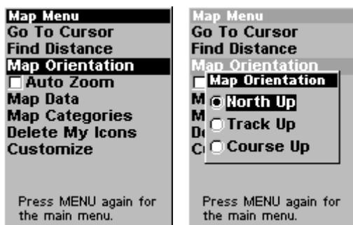
**Menu de la Carte, à gauche, Fenêtre d'Orientation de la Carte avec l'option d'orientation North Up (le Nord en haut) sélectionnée.**
