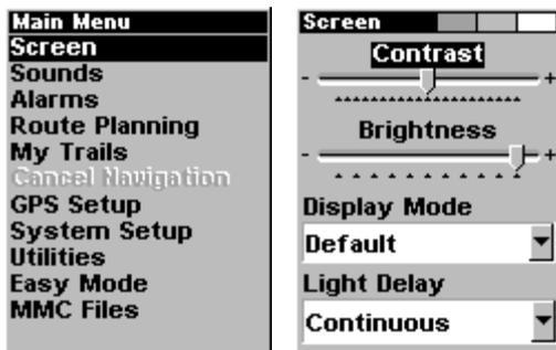
Commande Screen (Ecran), à gauche, et échelle de Contraste, à droite.
