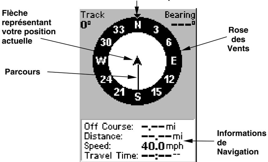
Écran de Navigation, enregistrant un trajet avec un déplacement vers le Nord. L'écran ressemble à celui-ci lorsque le iFINDER ne prend pas la direction d'un waypoint, ne suit pas un itinéraire ou n'est pas en fonction de backtrack.
