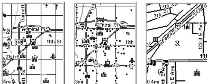
Ecran Cartographiques avec des cartes hautement détaillées d'une zone urbaine chargées sur MMC. A gauche, les grandes voies de communication apparaissent avec une portée de 4 miles, avec quelques Centres d'Intérêts visibles. Au centre, de nombreux points représentant les Centres d'Intérêts deviennent visibles avec une portée de 3 miles. A droite, avec une portée de 0.4 mile, vous pouvez voir une autoroute avec une sortie, les rues principales et secondaires ainsi que les Centres d'Intérêts.
