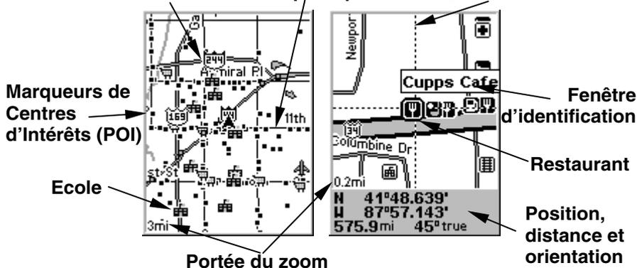
Lorsque la carte est observée avec suffisamment de recul, la plupart des POIs apparaissent sous la forme de petits carrés. Lorsque vous effectuez un zoom avant, les symboles deviennent des icônes lisibles. Dans l'exemple de droite, le curseur a sélectionné le Cupps Café comme POI, ce qui active une fenêtre automatique l'identifiant. Cette fenêtre fonctionne avec n'importe quelle portée de zoom.
