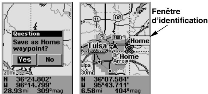
Menu de Sauvegarde du Point de Départ, à gauche. A droite, Point de Départ fixé, avec le symbole X et son nom. Lorsque le point de départ est sélectionné par le curseur, une fenêtre d'identification apparaît.
