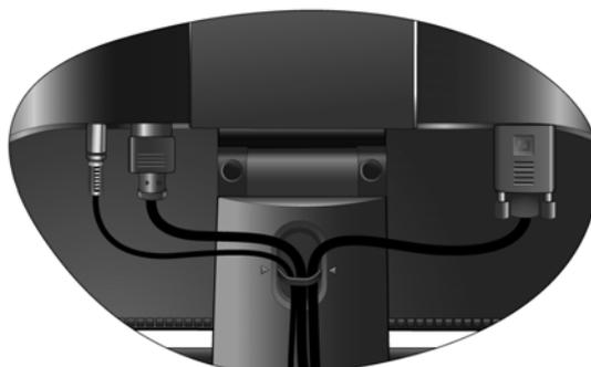
6. Connexion de l'alimentation et mise sous tension.
