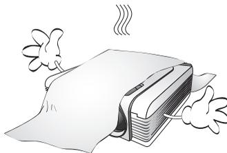
Une importante obstruction des orifices de ventilation peut entraîner une surchauffe de l'appareil qui risque alors de prendre feu.
