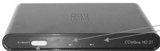
Emplacement des voyants lumineux indiquant l'entrée HDMI ('IN1' ou 'IN2') qui est sélectionnée.
