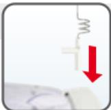
Insérer le guide-fil dans l'ouverture prévue à cet effet
