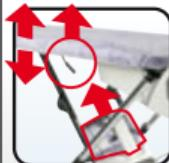
Régler la table dans sa position la plus élevée et retirer le réservoir d'eau froide
