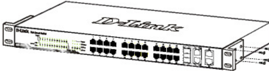
Figure 2 – Fixation des équerres de montage sur le Commutateur
