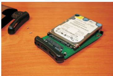
5. Positionnez le disque dur sur son emplacement, en face des connexions SATA.
