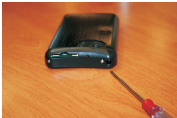
1. Dévissez les deux vis sur la face avant de la MINIPEEK.
