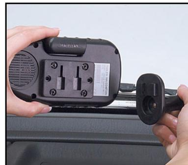
Pressez la ventouse contre le pare-brise et faites tourner la molette de verrouillage vers le pare-brise jusqu'à ce qu'elle se bloque.
