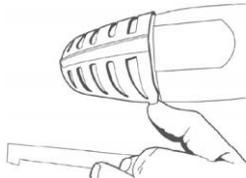
Pour remplacer l'ampoule, procédez de la façon suivante :
