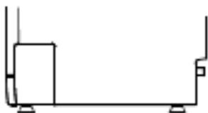
Une fois l'appareil en place, son horizontalité et sa hauteur peuvent être réglées en ajustant les pieds à vis. Dans tous les cas, l'appareil ne doit pas être incliné de plus de 2°.
