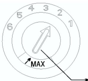
Le bouton de réglage du distributeur d'agent de rinçage est un sélecteur à 6 positions. Toujours démarrer sur la position "4". Si des traces apparaissent ou que le séchage est insuffisant, augmenter la quantité d'agent de rinçage en soulevant le capuchon du distributeur et en mettant le sélecteur sur "5". S'il reste encore des traces, régler sur le niveau encore supérieur jusqu'à obtenir un résultat parfait. Le réglage recommandé est de "4" (réglage usine).
