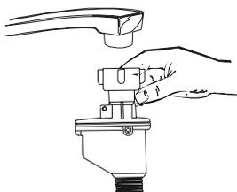
La lave-vaisselle doit être connectée à l'arrivée d'eau avec un ensemble de tuyaux neufs.
