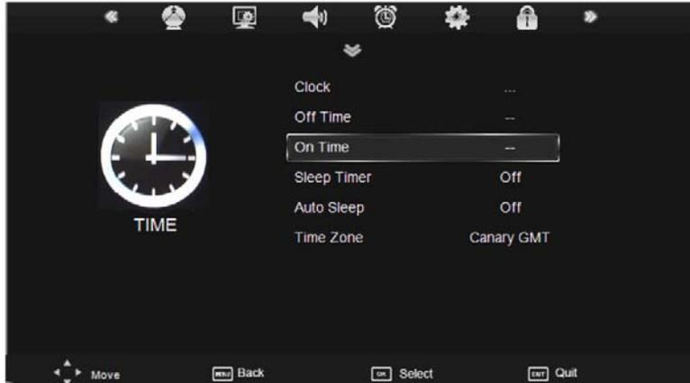
**Horloge** : Utilisez les touches < et > pour sélectionner la position, et utilisez les touches et pour régler l'heure.
