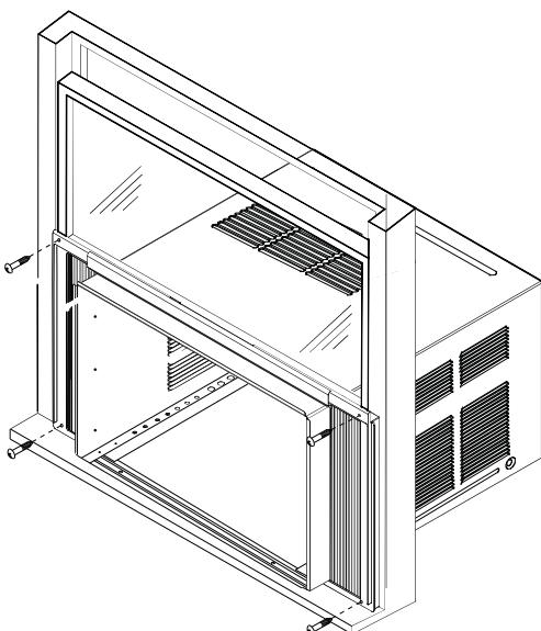
**REMARQUE:** Afin de faciliter l'introduction des vis, avec une perceuse, percez un trou de guidage dans le cadre de cette fenêtre en assant par le trou de dégagement situé dans les rideaux.
