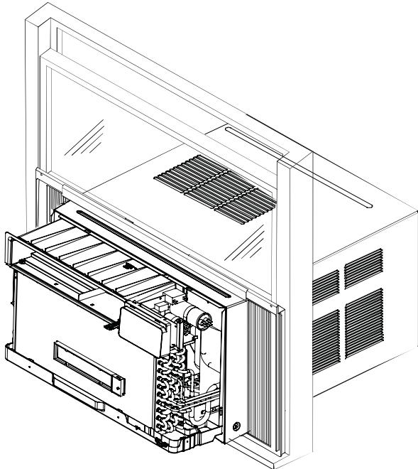
**Precaución:** Para propósitos de seguridad,reinstale los tornillos a los lados del gabinete.
