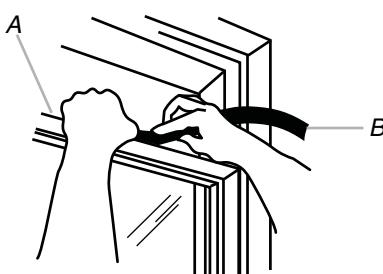
A. Sommet du châssis de la partie inférieure de la fenêtre.
