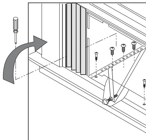
5. Utilisez une poulie en bois entre les boulons de réglage et le mur si le mur est fragile ou si le poids du climatiseur tombe entre les poteaux du mur.
