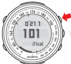
Appuyez sur UP, lorsque le chronomètre est en route, pour enregistrer un temps au tour et l'afficher sur la ligne supérieure. La FC moyenne et le numéro du tour sont également affichés. Après 3 s, l'affichage du temps chronométré réapparaît.
