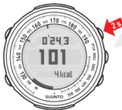
Appuyez longuement sur UP lorsque le chronomètre est arrêté pour le remettre à zéro. Lorsque vous remettez le chronomètre à zéro, les résumés ne sont pas effacés.
