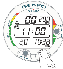
Fig. 3.28. . Intervalle surface, temps d'attente avant déplacement aérien. En appuyant sur le bouton TIME deux fois vous obtenez le temps d'attente avant déplacement aérien indiqué par le symbole en forme d'avion.
