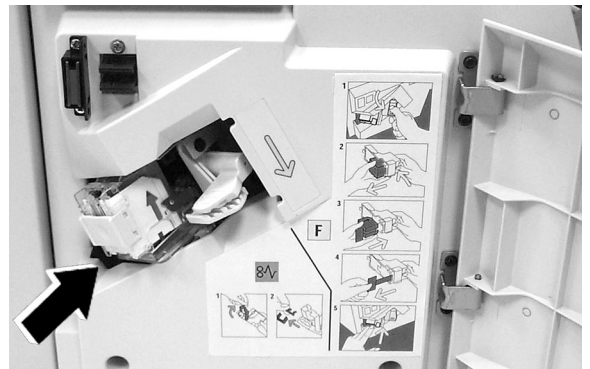
Figure 8 : insertion de la cartouche dans le logement correspondant
