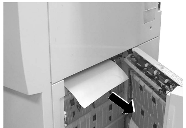
Figure 11 : retrait d'une feuille bloquée derrière le panneau droit de la machine
