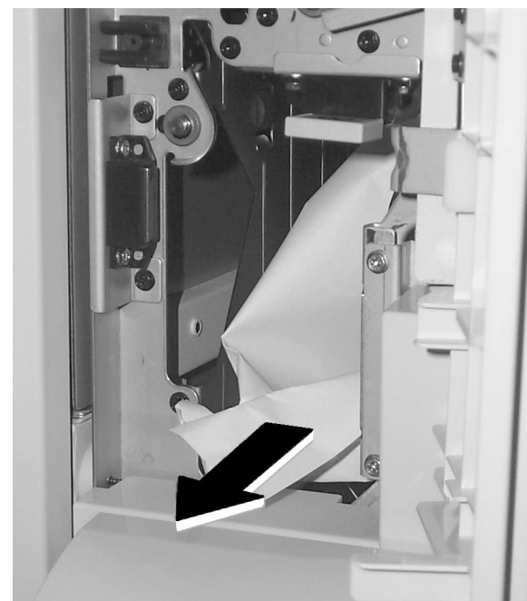
Figure 17 : retrait d'une feuille bloquée dans la zone 8
