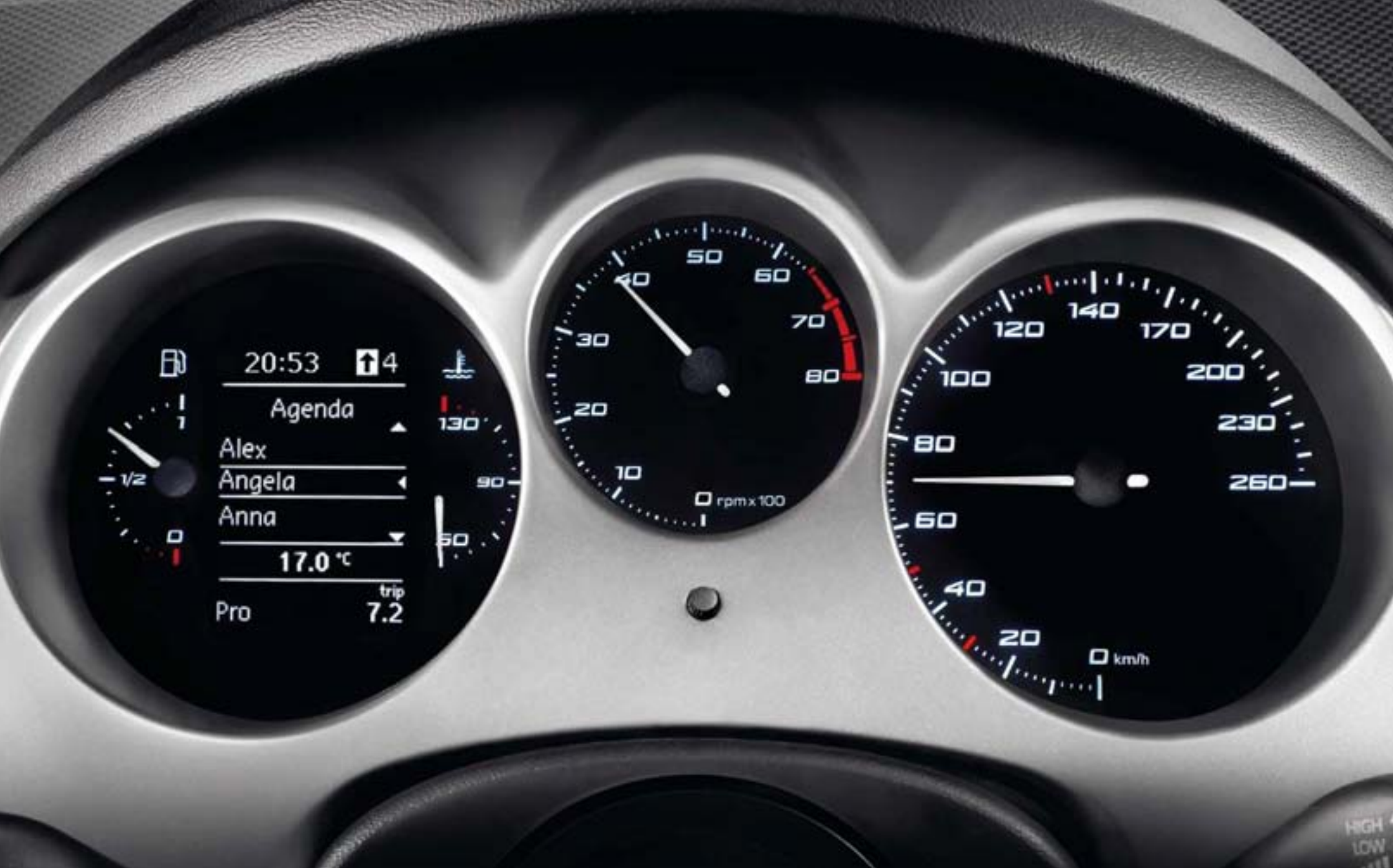
Le porte instrument adopte une typographie plus lisible. Les nouvelles motorisations sont équipées d'un indicateur de changement de rapport afin de maîtriser sa consommation en carburant.
