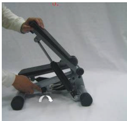
2. Draai de regelknop vast op het frame.
