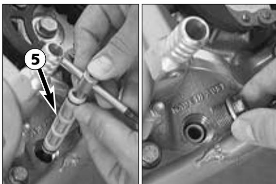
Pour monter la crépine longue ❺, l'enfiler sur une tige ou une clef d'environ 300 mm. Enfiler la tige par le trou et jusque dans l'alésage pratiqué dans la paroi opposée du carter. Faire alors glisser la crépine sur la tige jusqu'en butée. Retirer la tige, mettre le bouchon et le serrer à 15 Nm.
