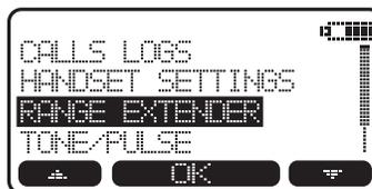
2. Sélection '**ON**' pour activer la fonction d'amplification de la portée '**RANGE EXTENDER**'. Un '**E**' apparaîtra à l'affichage vous indiquant que la fonction d'amplification de la portée '**RANGE EXTENDER**' est activée '**ON**'.
