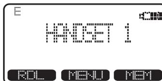
3. Sélectionnez '**AUTO**' pour permettre à votre **v 2651** pour effectuer le monitoring du signal entre le socle et le combiné et l'activer lorsque nécessaire. Lorsque la fonction d'amplification de la portée '**RANGE EXTENDER**' est activée, un '**E**' apparaîtra dans le coin supérieur gauche de l'écran d'affichage du combiné.
