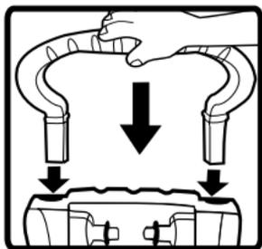
Enfoncer et tourner les taquets dans le sens des aiguilles d'une montre pour les resserrer. Tirer sur les pieds du trotteur pour s'assurer qu'ils sont bien fixés.
