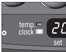
F: Når lampen CLOCK holder op med at blinke, er indstillingen fastlagt
