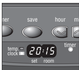
H: Lampka kontrolna TIMER oznacza, że funkcja programatora jest uruchomiona.
