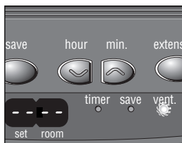
L: Wenn die Kontroll-Lampe VENT blinkt, ist dies ein Zeichen, daß zusätzlich ventiliert werden muß.
