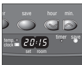
J: Når lampen SAVE lyser, slukkes eller tændes ovnen automatisk, sådan at temperaturen holder sig inden for et bestemt temperaturområde.
