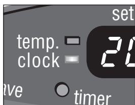
F: Als het lampje CLOCK niet meer knippert, staat de tijd vast ingesteld.
