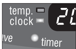
H: La spia luminosa di controllo TIMER indica che la funzione del timer è attiva.
