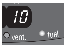
K: Si la lampe témoin FUEL s'allume, vous verrez sur l'afficheur numérique combien il vous reste de temps avant que l'appareil ne s'éteigne par manque de combustible.
