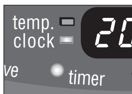
H: Het controlelampje TIMER geeft aan dat de timerfunctie is ingeschakeld.
