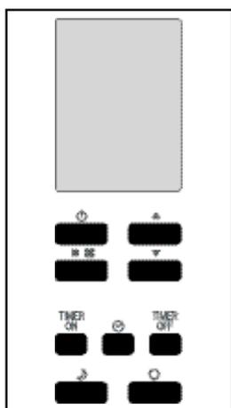
L'appareil répond à tous les signaux émis par la commande à distance ⑮. À chaque signal émis, le climatiseur émettra un bip de réception. La commande de l'appareil (voir Chapitre C) avec la télécommande est pratiquement la même que sur le panneau circulaire de commande.
