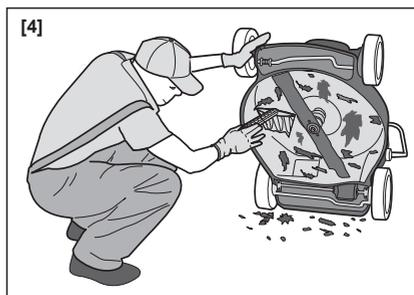
3. Au cas où il serait nécessaire d'accéder à la partie inférieure, incliner la machine exclusivement du côté indiqué dans le manuel du moteur, en observant les instructions relatives. Sur les modèles qui prévoient l'éjection latérale, il faut enlever le déflecteur d'éjection (s'il est monté).
