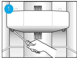
1 Enlever les cache-vis en dessous du boîtier d'éclairage avec un petit tournevis
