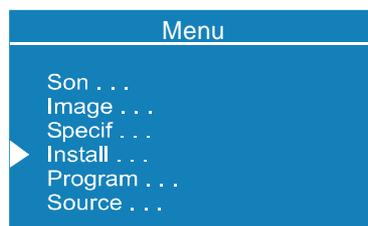
Lorsqu'un élément est sélectionné à l'aide des touches «Δ» ou «∇» dans le menu d'installation, l'élément sélectionné passe en surbrillance dans la barre inférieure. Les changements effectués à l'aide des touches «<» ou «>» n'ont d'effet que sur l'élément sélectionné dans la barre inférieure.
