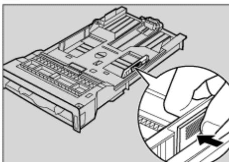
**5** Pincez l'attache du guide-papier avant du papier pour le régler sur le format de l'enveloppe.
