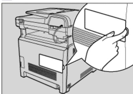
**3** Dévissez la vis de fixation du capot intérieur.
