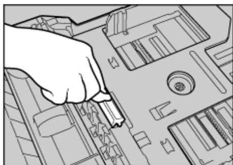
**5** Essuyez la partie en caoutchouc du rouleau avec un chiffon doux et humide. Ensuite, essuyez-la avec un chiffon sec pour retirer l'humidité.
