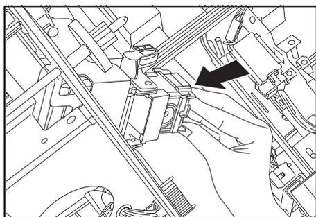
7. 斜めステーブルホルダー◎をステープルユニットの差し込み口に元通り挿入してください。完全に挿入されると、カチッとロックのかかる音がします。
