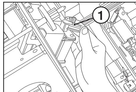
3. 斜めステーブルホルダー解除レバー①をつまんで斜めステーブルホルダー◎のロックを解除して、斜めステーブルホルダー◎を取り出してください。
