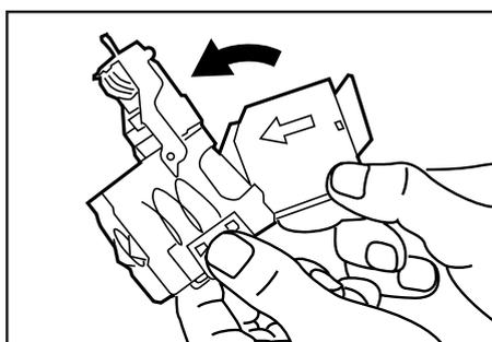
5. 片手に斜めステーブルホルダー◎、もう片方の手に新しい針カートリッジを持ち、向きに注意して針カートリッジを斜めステーブルホルダー◎に挿入してください。
