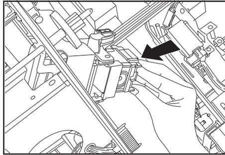
5. 斜めステーブルホルダー⑥をステーブルユニットの差し込み口に元どおり挿入してください。完全に挿入されると、カチッとロックのかかる音がします。
