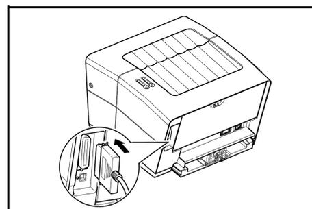
**REMARQUE :** Utilisez un câble imprimante parallèle conforme à la norme IEEE 1284. Pour garantir des performances optimales, installez l'imprimante près de l'ordinateur. Le câble de connexion doit être blindé et d'une longueur maximale de 3 mètres (10 pieds).
