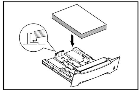
Lors du chargement du papier, ne dépassez pas la limite de hauteur indiquée par un triangle sur le guide de largeur.
