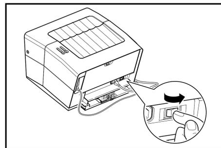
**IMPORTANT :** Si vous installez la *cartouche de toner*, puis mettez l'imprimante sous tension, deux voyants se mettent à clignoter. Lorsque l'imprimante est mise sous tension après l'installation du toner, un délai d'environ 15 minutes est nécessaire avant que l'imprimante soit prête à imprimer. Une fois que le voyant *Prêt* s'allume, l'installation de l'imprimante est terminée.
