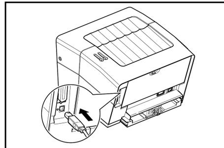
**REMARQUE :** Utilisez un câble USB muni d'une fiche rectangulaire de type A et d'une fiche carrée de type B. Le câble USB doit être de type blindé et d'une longueur maximale de 5 mètres (16 pieds).
