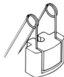
Le set de fixation magnétique MZM 10 et MZM 2 permet de fixer le microphone sans percer le tissu. Souvent, la force de frottement du tissu est suffisante pour tenir le micro en place. En cas de tissus lisses, la cordelette incluse offre une autre possibilité de support.
